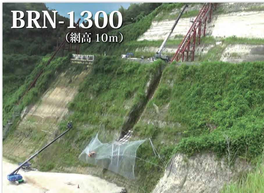
重錘を阻止面で受け止め、エネルギーを吸収
