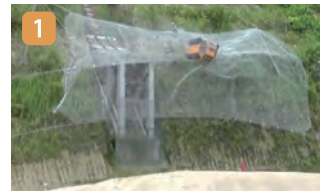
重錘を阻止面で受け止め、エネルギーを吸収
